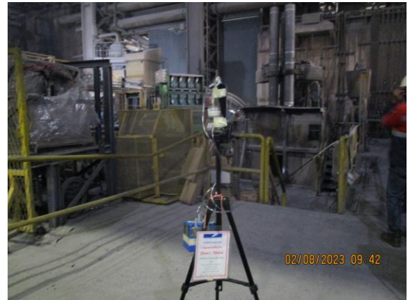
รูปที่ 4-65 ตรวจวัดคุณภาพอากาศบริเวณห่างจากเตาหลอม LF ประมาณ 10 เมตร เก็บตัวอย่างในวันที่ 2 สิงหาคม 2566
