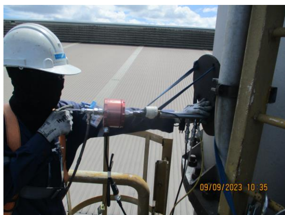
รูปที่ 4-46 ตรวจวัดคุณภาพจากปล่องระบายอากาศของโรงรีด 2 ตรวจวัดในวันที่ 9 กันยายน 2566
