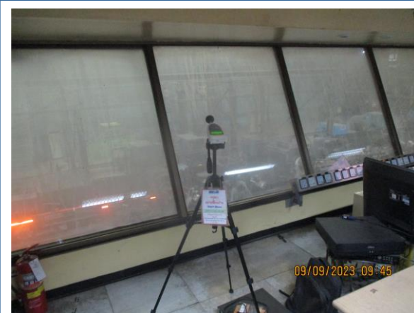
รูปที่ 4-56 ตรวจสอบระดับเสียงภายในห้องควบคุมของโรงรีด 1 ตรวจวัดในวันที่ 9 กันยายน 2566
