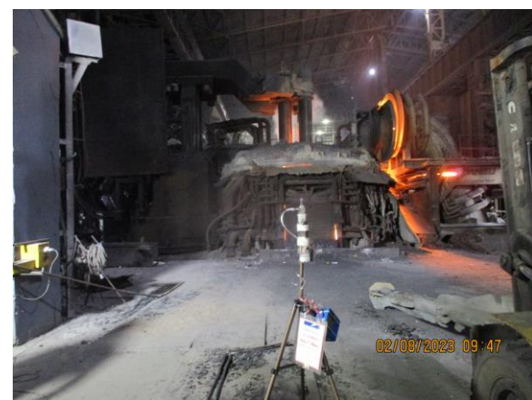
รูปที่ 4-62 ตรวจวัดคุณภาพอากาศบริเวณหน้าเตาหลอม EAF เก็บตัวอย่างในวันที่ 2 สิงหาคม 2566
