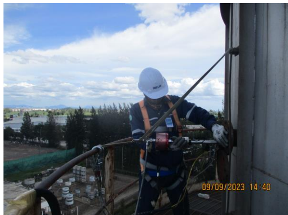
รูปที่ 4-44 ตรวจวัดคุณภาพจากปล่องระบายอากาศของโรงหลอม ตรวจวัดในวันที่ 9 กันยายน 2566
