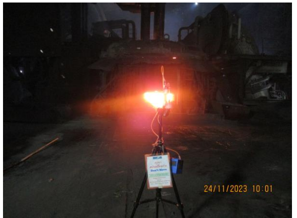
รูปที่ 4-67 ตรวจวัดคุณภาพอากาศบริเวณห่างจากเตาหลอม EAF ประมาณ 10 เมตร เก็บตัวอย่างในวันที่ 24 พฤศจิกายน 2566
