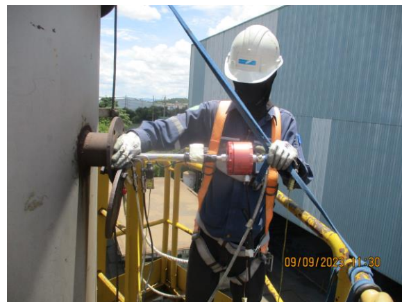
รูปที่ 4-45 ตรวจวัดคุณภาพจากปล่องระบายอากาศของโรงรีด 1 ตรวจวัดในวันที่ 9 กันยายน 2566
