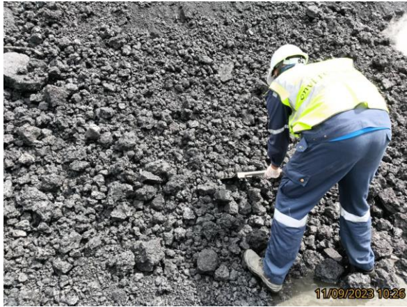
รูปที่ 4-52 เก็บตัวอย่างกากของเสียบริเวณที่กอง Slag จุดที่ 1 เก็บตัวอย่างในวันที่ 11 กันยายน 2566
