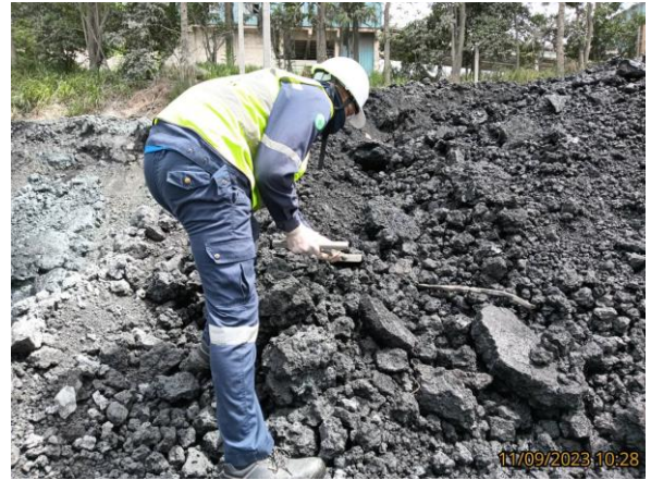
รูปที่ 4-53 เก็บตัวอย่างกากของเสียบริเวณที่กอง Slag จุดที่ 2 เก็บตัวอย่างในวันที่ 11 กันยายน 2566
