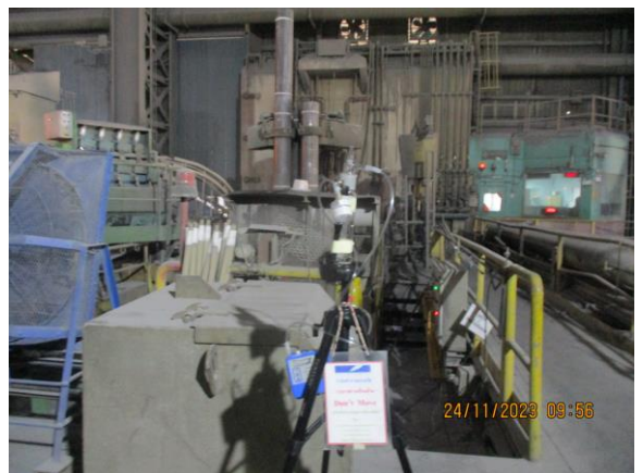
รูปที่ 4-69 ตรวจวัดคุณภาพอากาศบริเวณห่างจากเตาหลอม LF ประมาณ 10 เมตร เก็บตัวอย่างในวันที่ 24 พฤศจิกายน 2566
