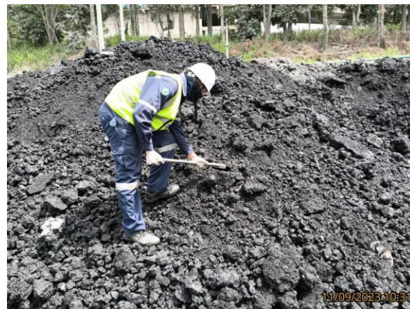
รูปที่ 4-54 เก็บตัวอย่างกากของเสียบริเวณที่กอง Slag จุดที่ 3 เก็บตัวอย่างในวันที่ 11 กันยายน 2566
