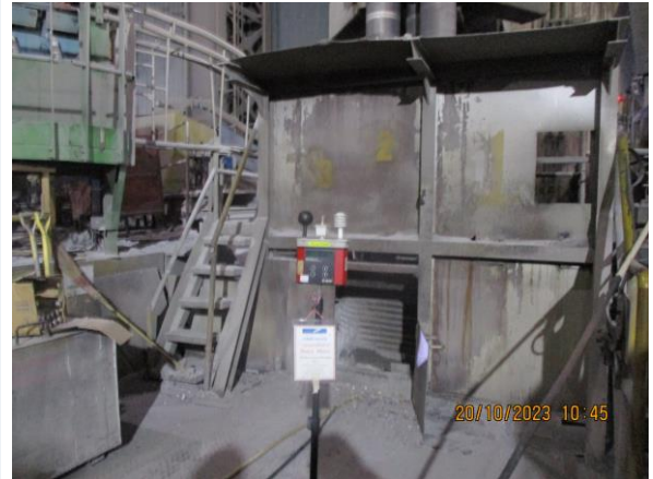
รูปที่ 4-59 ตรวจวัดระดับความร้อนบริเวณหน้าเตาหลอม LF ตรวจวัดในวันที่ 20 ตุลาคม 2566
