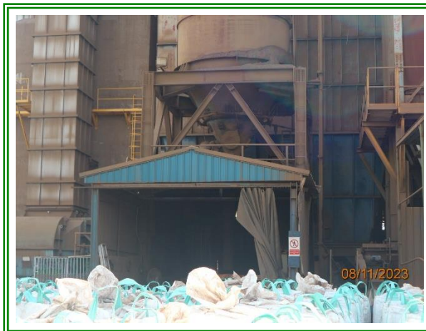
รูปที่ 3-25 โรงเก็บรวบรวมฝุ่น (Dust Silo) จากระบบดักฝุ่นแบบถุงกรอง (Bag Filter)
