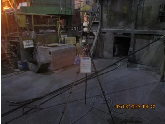
รูปที่ 4-64 ตรวจวัดคุณภาพอากาศบริเวณเตาหลอม LF เก็บตัวอย่างในวันที่ 2 สิงหาคม 2566
