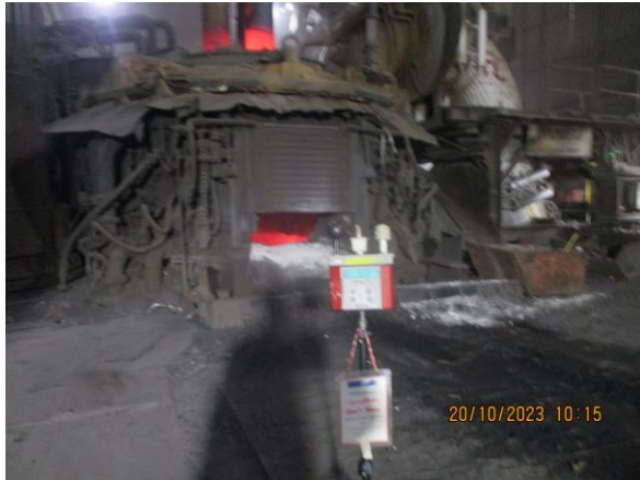
รูปที่ 4-58 ตรวจวัดระดับความร้อนบริเวณหน้าเตาหลอม EAF ตรวจวัดในวันที่ 20 ตุลาคม 2566
