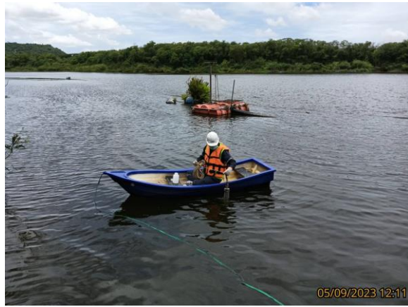
รูปที่ 4-47 แสดงการเก็บตัวอย่างคุณภาพน้ำผิวดิน บริเวณอ่างเก็บน้ำของบริษัท เก็บตัวอย่างในวันที่ 5 กันยายน และ 26 ธันวาคม 2566
