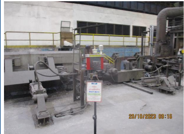
รูปที่ 4-61 ตรวจวัดระดับความร้อนบริเวณหน้าเตาอบเหล็กโรงรีด 2 ตรวจวัดในวันที่ 20 ตุลาคม 2566
