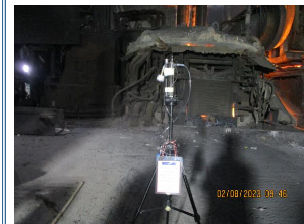
รูปที่ 4-63 ตรวจวัดคุณภาพอากาศบริเวณห่างจากเตาหลอม EAF ประมาณ 10 เมตร เก็บตัวอย่างในวันที่ 2 สิงหาคม 2566
